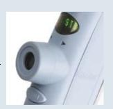
C'est le traitement intelligent de ces signaux qui permet au processeur interne de calculer avec précision, à chaque fraction d'une milliseconde, la position de l'instrument relativement à l'oeil du patient et de ne laisser survenir un événement (décharge d'air) que lorsque l'alignement est parfait.
